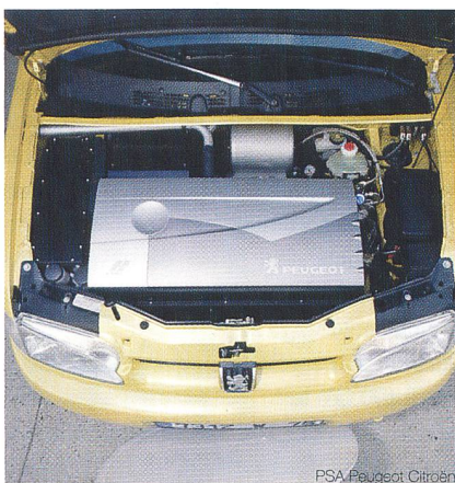
Compartiment moteur et pile à combustible du Peugeot Partner Taxi Pile A Combustible
