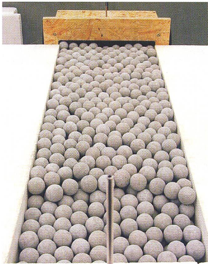
Des billes d'argile sont utilisées avec succès comme matériau de remplissage pour le déphaseur.
