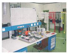
Ausbildungsplatz für Automatiker: Aufbau und Inbetriebnahme eines elektrischen Versuchs
