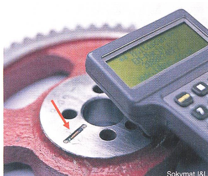
Figure 4 Transpondeur RFID à champ fort sous verre encollé dans le métal
