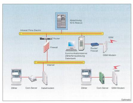
Bild 3 Prinzipschema der Zählerfernauslesung in Flims
