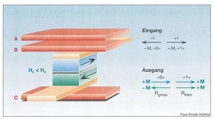
Bild 2 Prinzip eines magnetischen Logikelements
