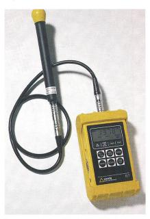
Exposure Level Tester ELT-400 von Narda Safety Test Solutions GmbH
