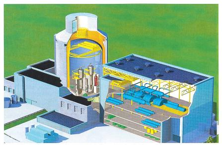
Schnittbild des Druckwasserreaktors AP 1000 (Advanced Passive Plant) von Westinghouse. Duke Power will in den USA den Bau zweier Reaktoren dieses Typs vorbereiten.
