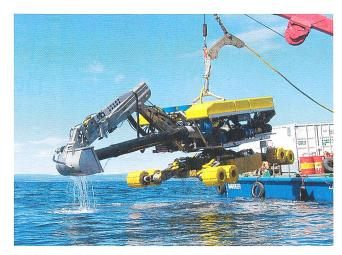
Das Fahrgestell für den Spider ist auf Basis einer Schweizer Forstmaschine entwickelt (Menzi-Muck im sanktgallischen Widnau), es wurde «marinisiert», d. h. umgerüstet, um in steilem Gelände unter Wasser arbeiten zu können.
