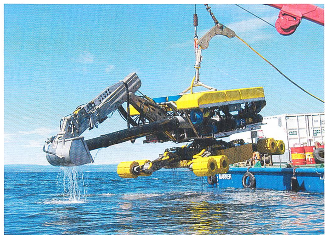
Das Fahrgestell für den Spider ist auf Basis einer Schweizer Forstmaschine entwickelt (Menzi-Muck im sanktgallischen Widnau), es wurde «mariniert», d. h. umgerüstet, um in steilem Gelände unter Wasser arbeiten zu können.
