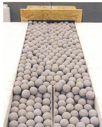
Tonkugeln eignen sich als Füllmaterial für den Phasenschieber. (CUEPE)
