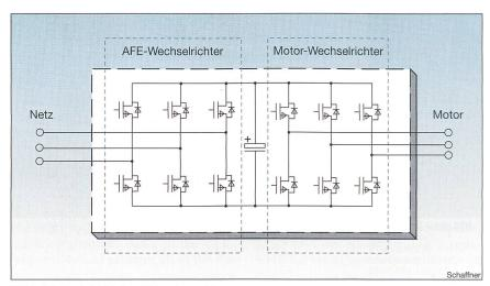
Bild 1 Prinzipschaltbild eines Rückspeiseantriebs
