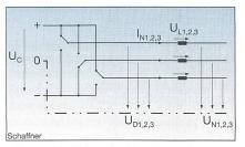
Bild 2 Wechselrichter als Rückspeiseeinrichtung
