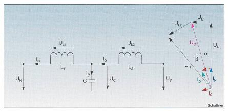
Bild 6 LCL-Filter und zugehöriges Zeigerdiagramm bei ohmscher Leistungsabgabe
