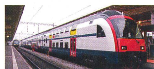
«Weichen für die Zukunft»: neuer ZVV-Doppelstock-Triebzug (Nennleistung: 3,2 MW; Bild SBB).
