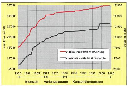
Bild 1 Bis 1950 vorwiegend Laufkraftwerke, danach vor allem Speicherkraftwerke, später Sanierungen und Ausbauten im Vordergrund.
