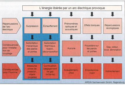
Fig. 1 Effets et conséquences d'un arc électrique
