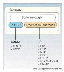
Bild 3 Schnittstellen am Gateway
