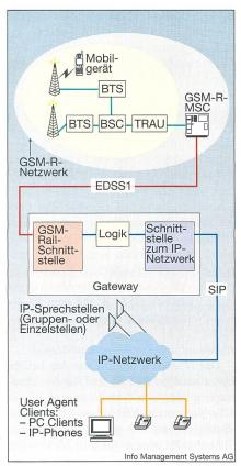
Bild 1 Der Gateway als Bindeglied zwischen GSM-R und VolP
