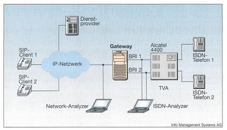
Bild 5 Tests ISDN to SIP
