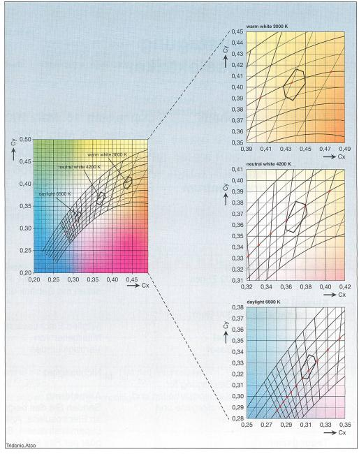
Bild 3 Farbtoleranzwerte für Weisslichtemission
