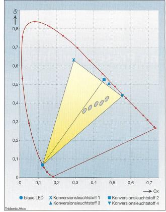
Bild 2 CIE-Diagramm mit darstellbarem Farbdreieck
