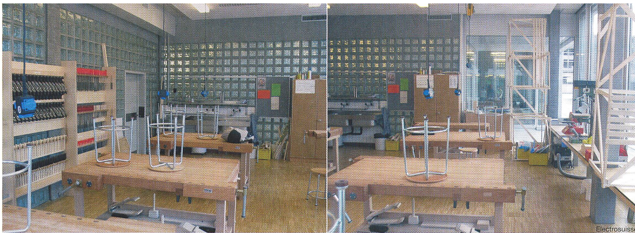
Bild 2 Tageslicht (rechts) und künstliches Licht (links) wirken anders auf den Benutzer. Zudem muss der Schattenwurf beim Tageslicht beachtet werden – zum Beispiel bei Arbeiten mit dem Rücken zum Fenster.
