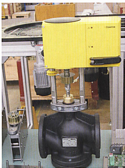
Die bei Fr. Sauter AG entwickelten und hergestellten Komponenten (Bild: Ventil- und Klappenantrieb) müssen mit Hilfe von automatischen Abläufen auf ihre Funktionalität geprüft werden.
