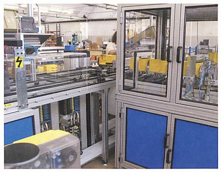
Diese Montage- und Prüflinie für Ventilantriebe ist ein typisches Anwendungsgebiet für Automatiker
