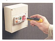
Einfache Spannungsprüfung mit dem Fluke 1AC-II
