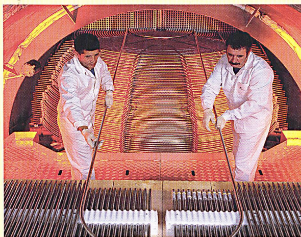
Fertigung von Dampferzeugern bei Areva (Bild Areva).
