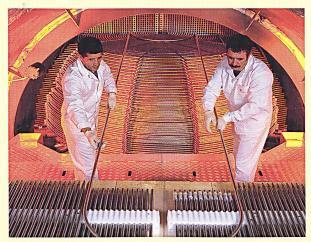
Fertigung von Dampferzeugern bei Areva (Bild Areva).
