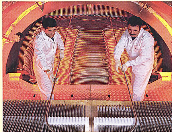
Fertigung von Dampferzeugern bei Areva (Bild Areva).
