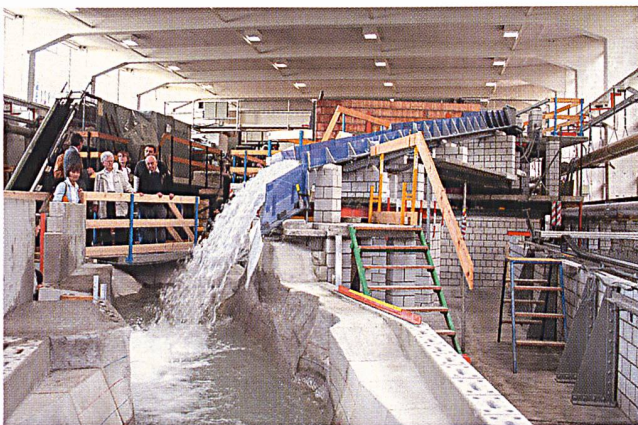
Mit Hilfe dieser Anlage klären VAW-Forscher ab, wie der Hochwasserüberlauf bei einem Kraftwerk optimal gestaltet werden kann.
