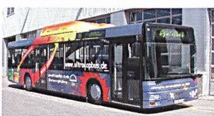
Fahrzeug mit Diesel-elektrischem Antrieb und Ultracap-Speicher.
