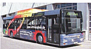
Fahrzeug mit Diesel-elektrischem Antrieb und Ultracap-Speicher.
