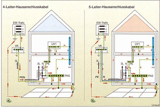
Bild 1 Vergleich der Ausgleichsströme bei Vierleiter- und Fünfleiter-Hausanschlusskabeln
