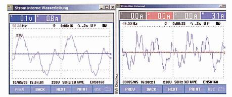
Bild 2 Ausgleichsströme in Wasserleitungs- und Erdungsstrukturen
