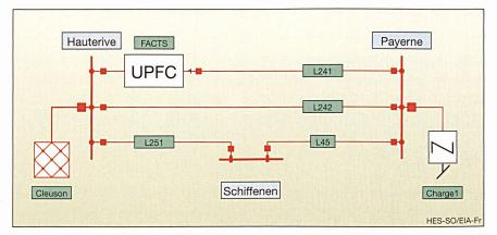
Figure 7 Topologie choisie dans le simulateur analogique
