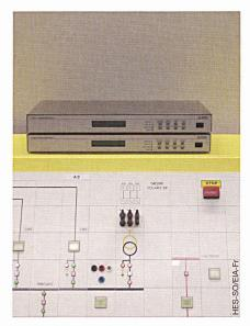
Figure 6 Mesureurs de phaseurs connectés au simulateur analogique et au système de surveillance globale («WAMS»)<sup>4)</sup>
