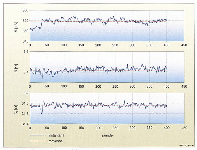
Figure 5 Paramètres de ligne obtenus avec des mesureurs de phaseurs
