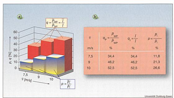
Bild 2 Einfluss der mittleren Windgeschwindigkeit auf die Zeitmittelwerte der Windparkleistung  $P_{WP}$  Kabelstrom / und Verlustbelag  $P_1'$  eines Kabelsystems für eine kurze Kabellänge mit  $I_0 \approx 0$
