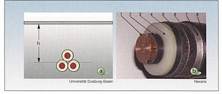
Bild 1 Untersuchte Anordnung (links) und Aufbau des 150-kV-Kabels
