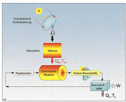
Bild 1 Schematische Darstellung der Umwandlung von Sonnenerergie in solare Brennstoffe
