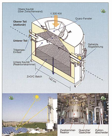
Bild 6 Solzinc-Pilotanlage
