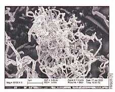
Bild 9 Kohlenstoff-Nanofasern, entstanden bei der solarthermischen Zersetzung von CH<sub>4</sub>, aufgenommen mit dem Rasterelektronenmikroskop (REM) [1]
