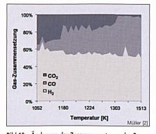
Bild 10 Änderung der Zusammensetzung des Produktgases (gemessen mit einem Gaschromatographen) als Funktion der Temperatur der Wirbelschicht während der solaren Dampfvergasung von Kohle [2]
