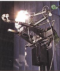
Bild 8 Solarchemischer Reaktor
