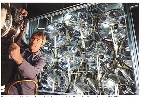
Konzentriertes künstliches Sonnenlicht durch zehn starke Xenon-Lichtbogen-Lampen (Bild PSI).
