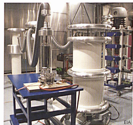
Hochspannungslabor der EIA Fribourg mit der 200-kV/50-Hz-Anlage
