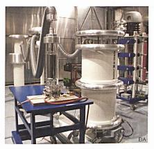
Hochspannungslabor der EIA Fribourg mit der 200-kV/50-Hz-Anlage
