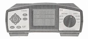
Zeitgleiche, echte Effektivwertmessung (RMS) über 6-Kanäle (3 x U + 3 x I) 128 Abtastungen pro Periode; registriert Ereignisse > 20µsec Minimal-, Maximalwerte; Mittelwertkalkulation für gespeicherte Grössen
