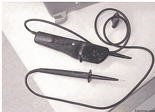
Fig. 4 L'électricien de réseau a déclenché un court-circuit avec le Dupsol
