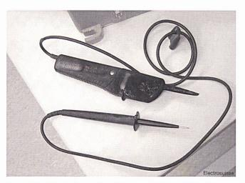
Fig. 4 L'électricien de réseau a déclenché un court-circuit avec le Duspol
