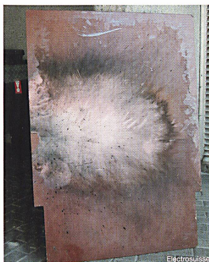
Fig. 9 De la vapeur de cuivre s'est déposée sur la plaque. Heureusement, la plaque a tout de même un peu protégé le monteur.
