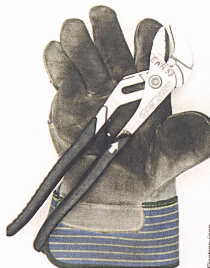
Fig. 13 Les gants de cuir ne protègent pas de la tension. La pince ne convient pas car elle n'est pas isolante.
