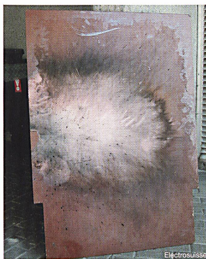
Fig. 9 De la vapeur de cuivre s'est déposée sur la plaque. Heureusement, la plaque a tout de même un peu protégé le monteur.
