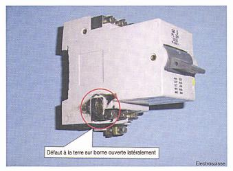
Fig. 7 Borne ouverte sous tension
