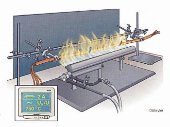
Bild 1 Prüfung auf Isolationserhalt (FE) nach IEC 60331
