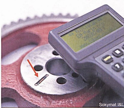
Bild 4 Glasgekapselter RFID-Nahfeldtransponder, eingeklebt in Metall
