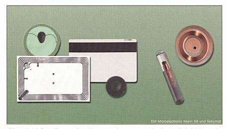
Bild 1 Beispiele für Bauformen und Kapselung von Spulenantennen. Bei den Glas-Tags (rechts) sieht man den Ferritkern mit aufgewickelter Kupferdrahtspule als Antenne aus der Vergussmasse herausragen.
