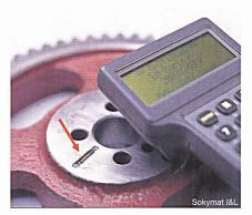
Bild 4 Glasgekapselter RFID-Nahfeldtransponder, eingeklebt in Metall
