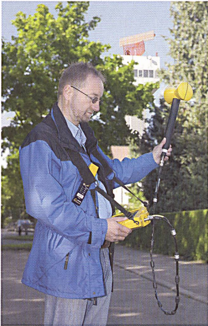
Mesure des champs pulsés avec le système SRM3000 de Narda
