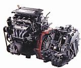
Hybridmotor: rechts der Elektromotor (Bild Honda).
