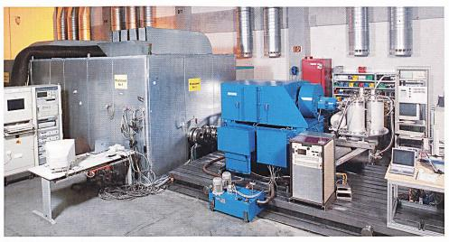
Der HTS-Generator wird einem umfassenden Systemtest unterzogen.
