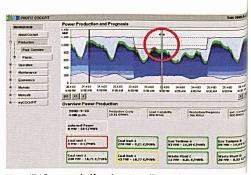
Neue IT-Lösungen helfen dem Betreiber, seine Entscheidungen zu treffen. Das System bezieht alle Einflussgrössen wie prozesstechnische Zustände, Massnahmen für Wartung und Reparatur, Brennstoffkosten, Betriebskosten und mögliche Verkaufserlöse in die Bewertung ein.
