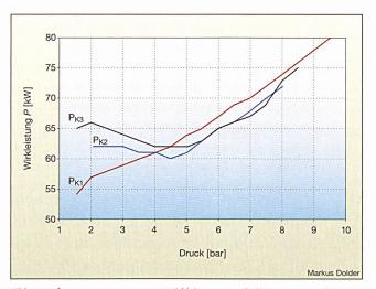
Bild 4 Aufgenommene gemessene Wirkleistung von drei Kompressoren in Abhängigkeit des Behälterdrucks
