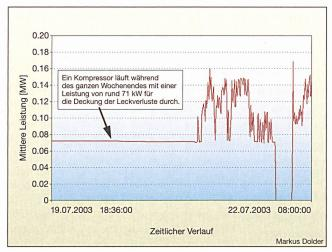
Bild 3 Leistung aller Druckluftkompressoren bei Schilliger Holz AG
