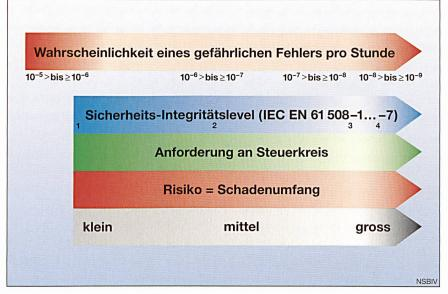
Bild 5 Sicherheits-Integritätslevel nach IEC EN 61508-1...-7
