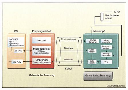
Bild 5 Struktureller Aufbau des entwickelten Messdatenerfassungssystems
