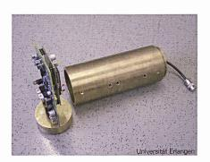
Bild 3 Kopfeinheit des Messdatenerfassungssystems mit digital verstellbarem Eingangssignalverstärker, galvanischer Trennung, Micro-Controller-basierte Steuerelektronik, Referenz-/Digitalisierungseinheit und Leitungstreibern
