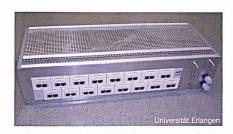
Bild 8 Die Empfangseinheit des Messsystems beinhaltet das Netzteil, die Messsignalempfänger und den Protokollumsetzer, der zwischen Hauptrechner und den 32 Messkopf-Controllern vermittelt
