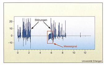
Bild 2 Typischer Sekundärstrom, aufgezeichnet mit der alten analogen Messtechnik; rot umrandet das eigentliche Messsinnal
