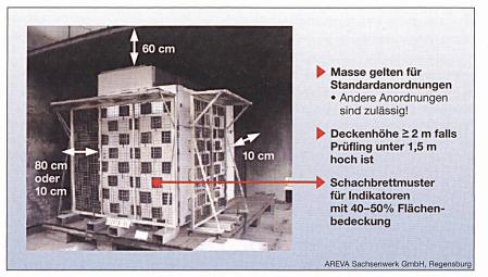
Bild 3 Standardanordnung für Störlichtbogenprüfung, mit Raumnachbildung
