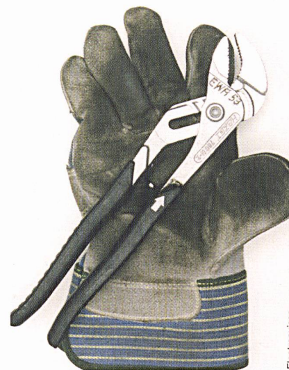
Bild 13 Lederhandschuhe schützen nicht vor anstehender Spannung. Die Zange ist ungeeignet, da nicht isolierend.
