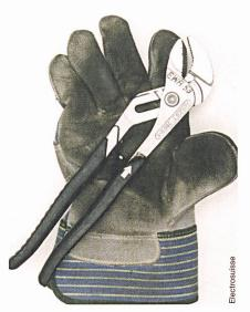
Bild 13 Lederhandschuhe schützen nicht vor anstehender Spannung. Die Zange ist ungeeignet, da nicht isolierend.
