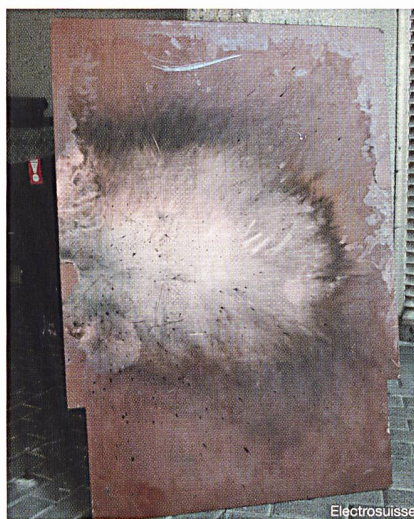
Bild 9 Kupferdampf hat sich auf die Platte niedergeschlagen. Glücklicherweise hat die Platte den Monteur doch etwas geschützt.
