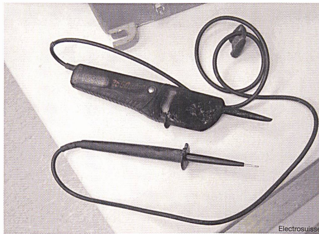
Bild 4 Der Netzelektriker löste mit dem Duspol einen Kurzschluss aus
