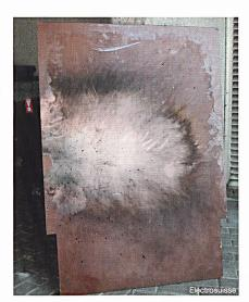
Bild 9 Kupferdampf hat sich auf die Platte niedergeschlagen. Glücklicherweise hat die Platte den Monteur doch etwas geschützt.
