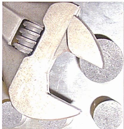
Foto einer Probe aus Stahl und Kohlenstoff: Im Neutronenbild rechts sind auch die vom Schraubenschlüssel verdeckten Kohlenstoffscheiben abgebildet.
