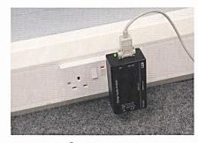
Datenlogger zur Überprüfung der Netzspannungsqualität VLog Q von LEM Elmes
