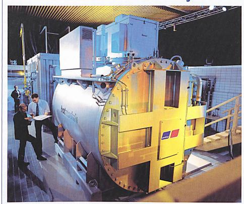
Die Brennstoffzelle («Hot Module») vom Typ MCFC (Molten Carbonate Fuel Cell, Schmelzkarbonat Brennstoffzelle) arbeitet bei einer Temperatur von rund 650°C (Bild MTU).
