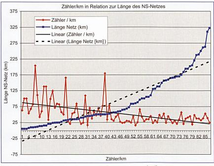
Bild 1 Anzahl Zähler je Kilometer und Länge des Niederspannungsnetzes in Kilometer.4
