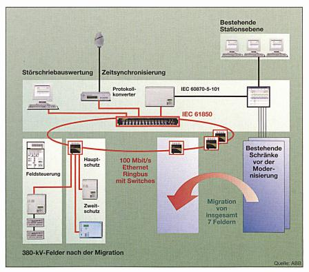
Bild 4 Die neue Systemkonfiguration
