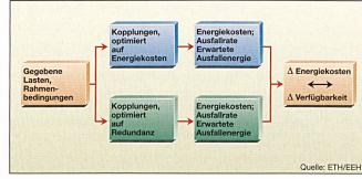
Bild 7 Schematische Darstellung einer Methode zur Gegenüberstellung Verfügbarkeit und Betriebskosten
