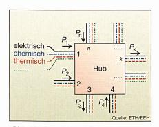
Bild 3 Die allgemeine Darstellung eines Energy Hubs mit beliebig vielen Zugängen; die Flussrichtungen an den Zugängen sind frei definierbar
