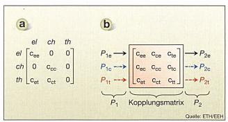
Bild 2 Kopplungsmatrix für das Haushaltbeispiel aus Bild 1; allgemeine Form der Kopplungsmatrix (elektrisch: schwarz, chemisch: blau, thermisch: rot)
