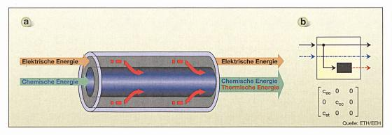
Bild 5 Symbolische Darstellung eines Energy Interconnectors; Darstellung als Energy Hub mit der dazugehörigen Kopplungsmatrix
