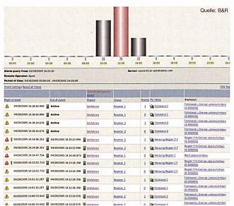
Bild 2 Ein Säulendiagramm zeigt eine chronologische Häufigkeitsverteilung der Alarme und Meldungen
