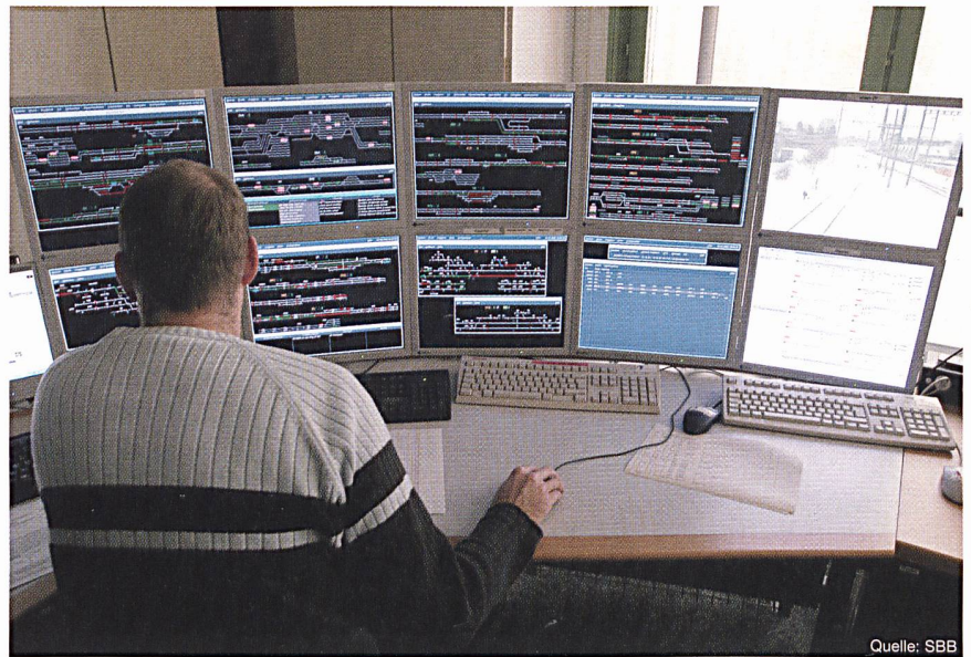
Bild 7 Fahrdienstleiter-Arbeitsplatz im Fernsteuerzentrum Olten (integrierte Leittechnik)
