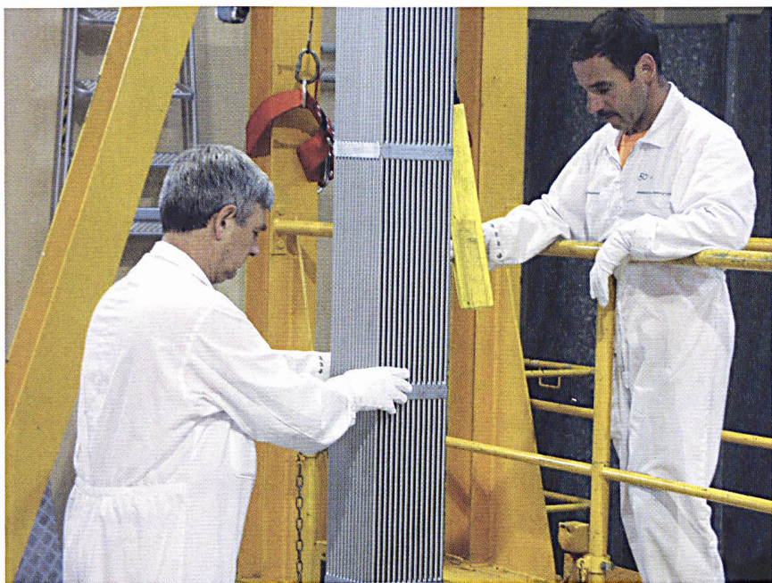
Eines der vier in England gefertigten MOX-Brennelemente, die im neuen Betriebszyklus im KKB zum Einsatz kommen (MOX steht für Mischoxyd-Kernbrennstoff) (Bild: nok).
