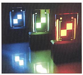
Bild 2 OLED-Displays in drei verschiedenen Farben unter Glas.
