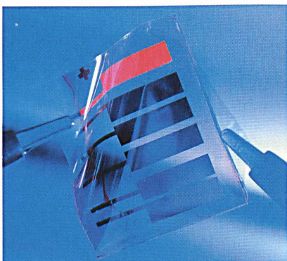
Bild 1 Beim flexiblen Display sind die empfindlichen leuchtenden Polymere in sehr gasdichte Barrierefolien eingebettet.
