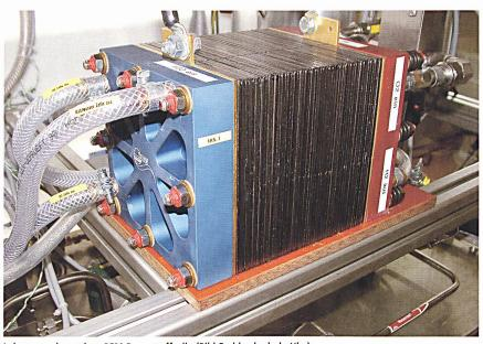
Laborversuch an einer PEM-Brennstoffzelle (Bild Fachhochschule Ulm).
